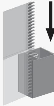
La toile est insérée dans les glissières latérales à l'aide d'un mécanisme de fermeture éclair fournissant un joint étanche aux insectes qui ne peuvent pas pénétrer.
